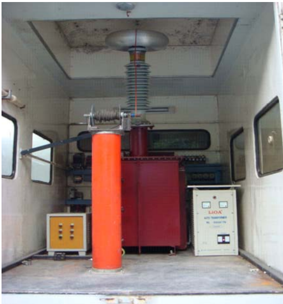
Xe công trình thí nghiệm cao áp TransHV 250kV
