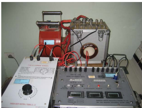
Hợp bộ kiểm định đo lường máy biến dòng điện/máy biến điện áp
